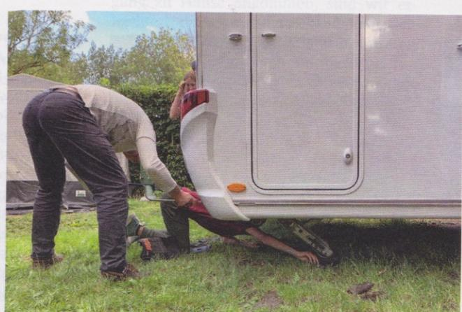
Wie war das noch mit dem Abstützen? Unterlegplatten bereitlegen, Stützen auskurbeln. Der Sohn schaut auf dem Bauch liegend genau hin.
